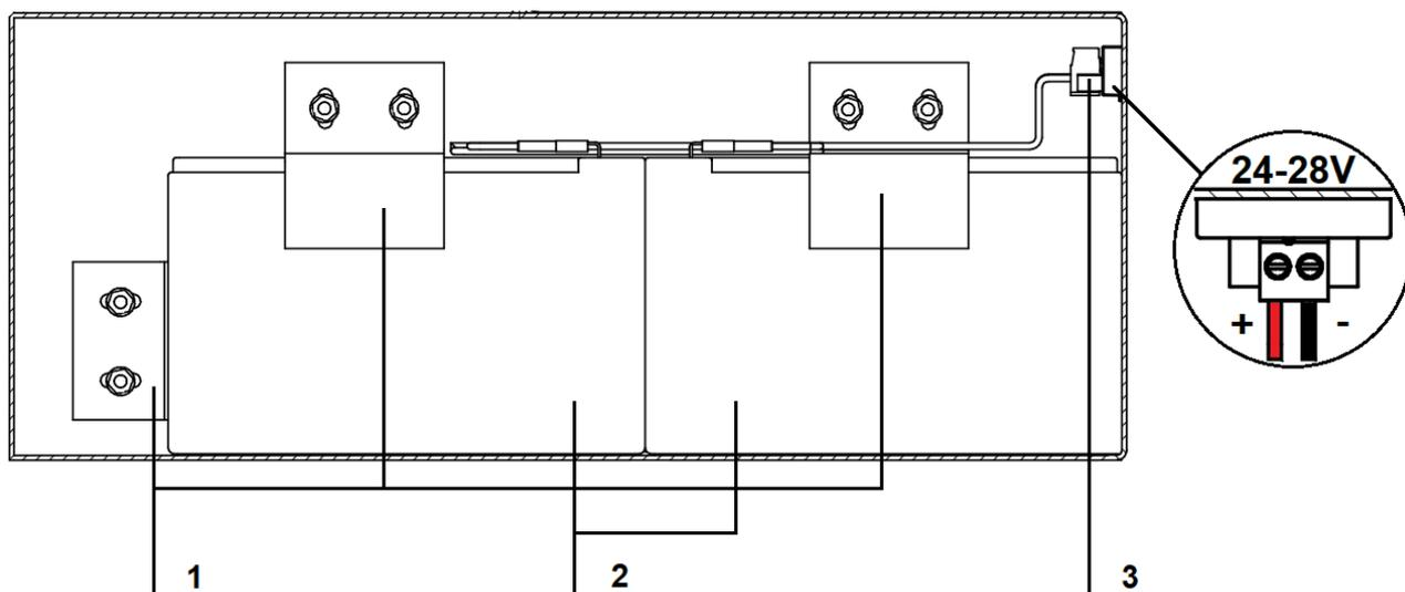
Рисунок 3 - Отсек установки аккумуляторных батарей. Размещение АКБ.
