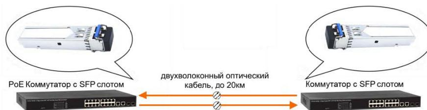
*Рисунок 5 - Схема подключения комплекта SFP модулей*
